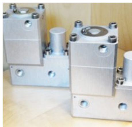
Détendeur double étage hydrogène 400 bars entrée - 1 à 1,5 bars sortie
